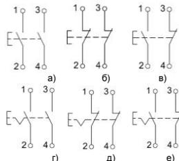
Рисунок 4. Принципиальные электрические схемы кнопки управления типа OptiDin KM63-А и типа OptiDin KM63-АF:
