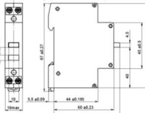
Рисунок 3. Габаритные, установочные и присоединительные размеры кнопки управления типа OptiDin KM63- С и OptiDin KM63- CF
