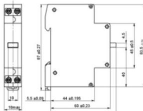
Рисунок 1. Габаритные, установочные и присоединительные размеры кнопки управления типа OptiDin KM63- А и OptiDin KM63- АF
