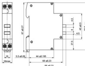
Рисунок 2. Габаритные, установочные и присоединительные размеры кнопки управления типа OptiDin KM63- В
