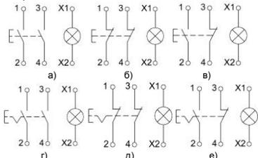
Рисунок 6. Принципиальные электрические схемы кнопки управления типа OptiDin KM63-C и типа OptiDin KM63-CF со встроенным световым индикатором зеленого цвета:
